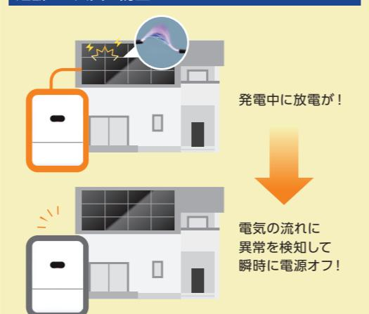
「アーカー障害回路遮断器(AFCI)」という火災防止機能を搭載。
